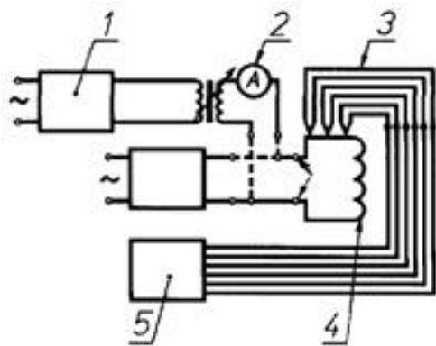
1 - стабилизатор; 2 - амперметр; 3 - термопары; 4 - обмотки печи; 5 - потенциометр
