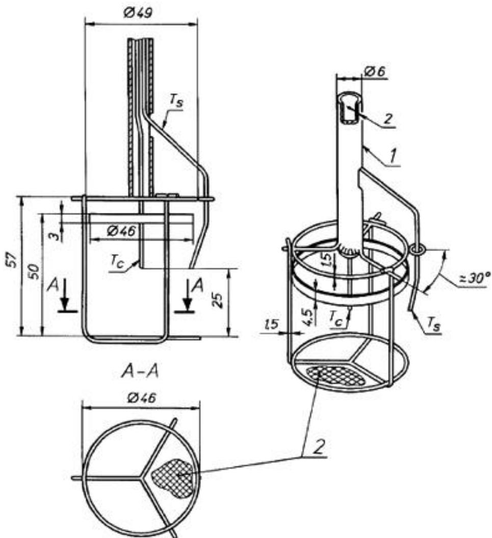
$T_C$  - термопара в центре образца;  $T_S$  - термопара на поверхности образца;
