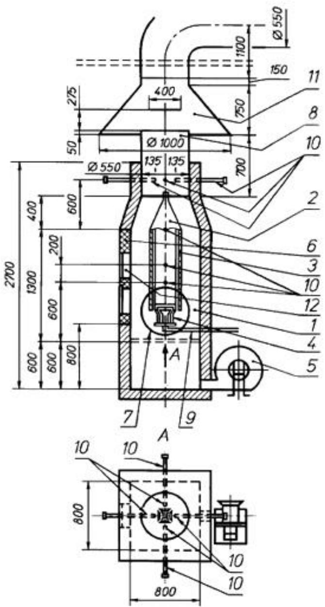
1 - камера сжигания; 2 - держатель образца; 3 - образец; 4 - газовая горелка; 5 - вентилятор подачи воздуха; 6 - дверца камеры сжигания; 7 - диафрагма; 8 - вентиляционная труба; 9 - газопровод; 10 - термопары; 11 - вытяжной зонт; 12 - смотровое окно
