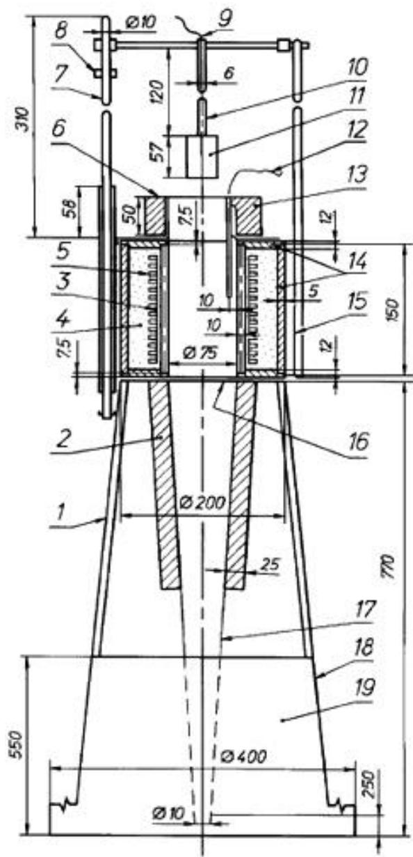
1 - станина; 2 - изоляция; 3 - огнеупорная труба; 4 - порошок окиси магния; 5 - обмотка; 6 - заслонка; 7 - стальной стержень; 8 - ограничитель; 9 - термопары образца; 10 - нержавеющая стальная трубка; 11 - держатель образца; 12 - печная термопара; 13 - изоляция; 14 - изоляционный материал; 15 - труба из асбестоцемента или аналогичного материала; 16 - уплотнение; 17 - стабилизатор потока воздуха; 18 - листовая сталь; 19 - защитное устройство от сквозняка
